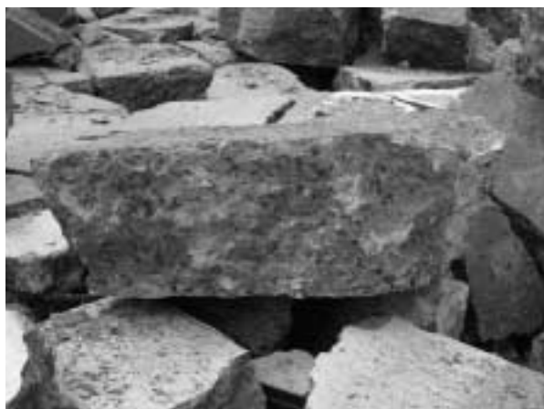
Obr. 2: RWY 13-31, vybouraný kvalitní beton horní desky.
